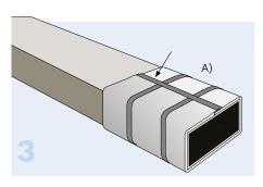
Fissaggio del sormonto di giunzione longitudinale di Tekno-Fire con lo stesso nastro adesivo
