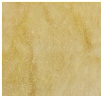
La lana di vetro è un materiale costituito da fibre sottili ottenute dalla fusione di sabbia e altri componenti in un processo ad alta temperatura, in grado di offrire ottime prestazioni di isolamento termico e acustico.
