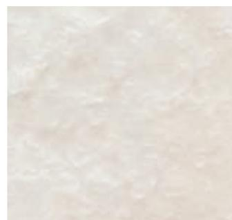
La fibra ceramica, leggera e refrattaria, resiste a oltre 1000°C ed è usata nell'industria e per la produzione di forni e impianti. Ideale per l'isolamento in situazioni di temperature estreme.
