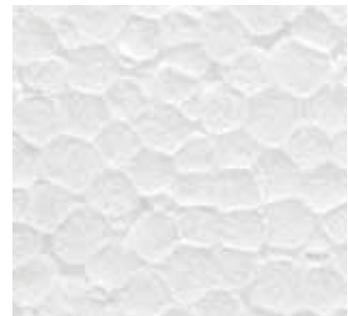
L'EPS (Polistirene Espanso Sinterizzato) è un materiale plastico leggero, versatile e altamente performante, molto utilizzato in edilizia per l'isolamento termico di pareti, pavimenti e tetti.
