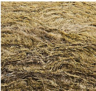
La lana di roccia, ottenuta da rocce vulcaniche fuse e filate in fibre, offre eccellenti proprietà di isolamento termico, acustico e resistenza al fuoco, garantendo elevate prestazioni in ogni applicazione.
